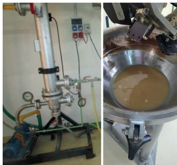
Figura 5. Olla con camisa de vapor acoplada a una bomba de vacío para concentrar lactosuero
