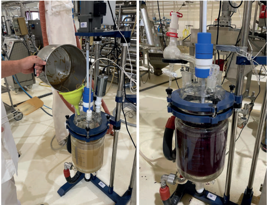
Figura 5. Equipo para la extracción asistida mediante ultrasonidos modelo "RE-605"
