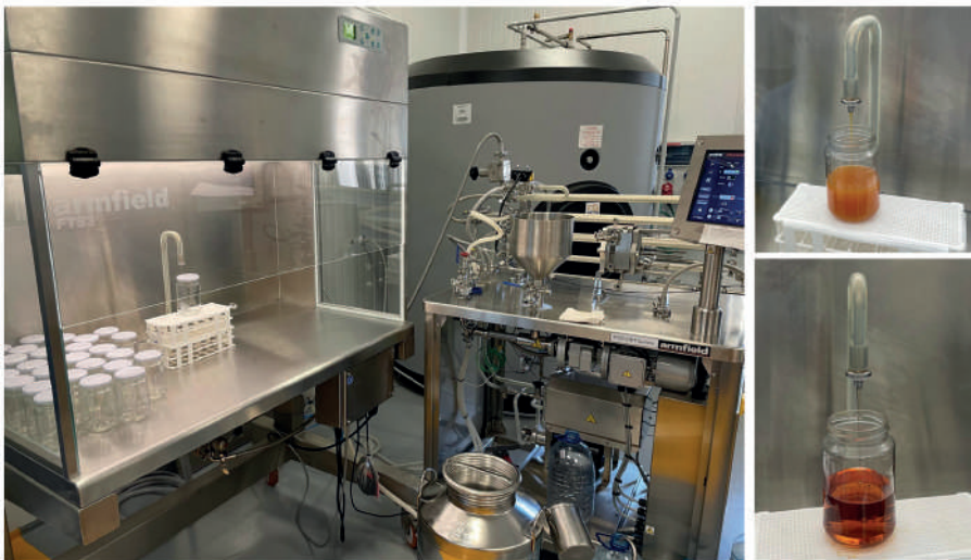
Figura 7. Tratamiento térmico UHT en zumos con extracto. Llenado en campana de flujo laminar.
