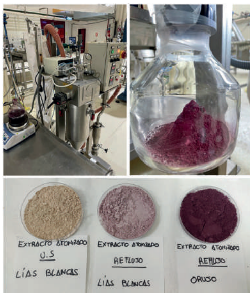
Figura 6. Obtención de atomizados de cada uno de los extractos conseguidos mediante extracción reflujo y asistida mediante ultrasonidos.
