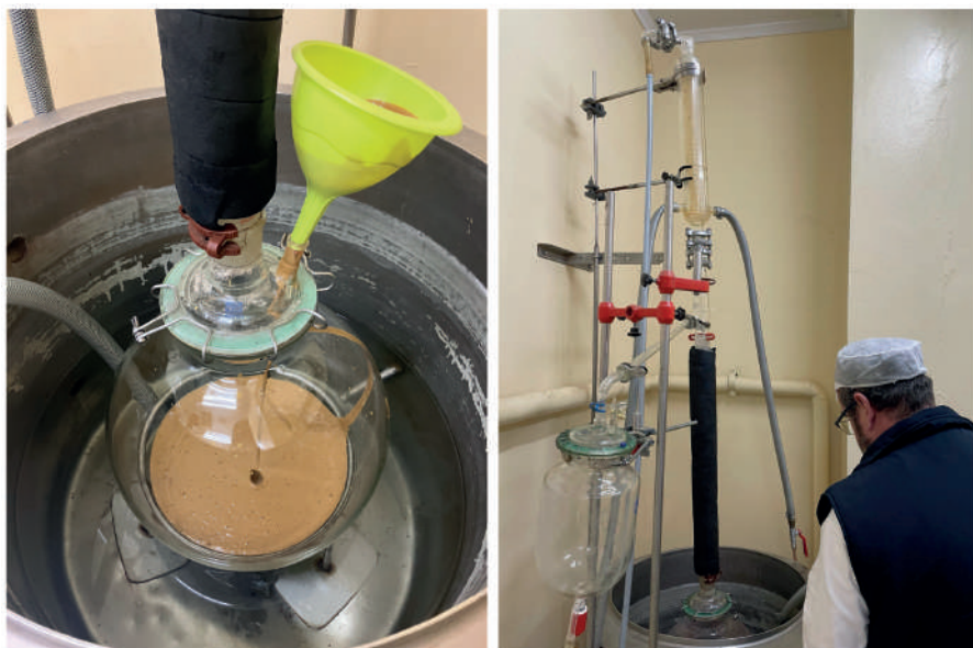
Figura 4. Equipo para la extracción a reflujo con solventes orgánicos
