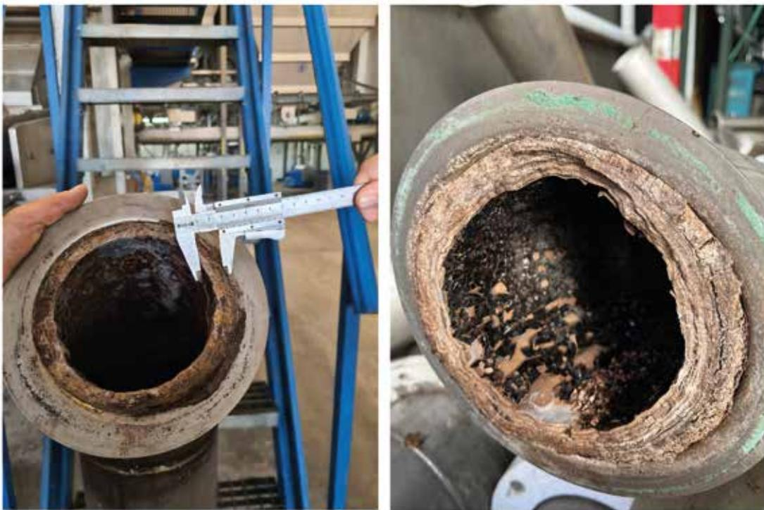
Figura 4. La acumulación de capas de pasta de aceituna en las tuberías provoca la pérdida de carga de las bombas a la vez que afecta a la calidad del aceite extraído. Imágenes cedidas por Química Verde Masul SL.
