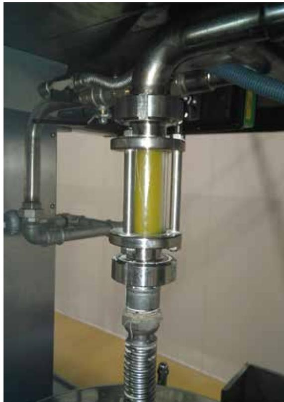
Figura 3. El ajuste de la centrifuga vertical para un óptimo funcionamiento es clave para reducir el consumo de agua y el contenido de sólidos en suspensión de los aceites antes de enviarlos a bodega.
